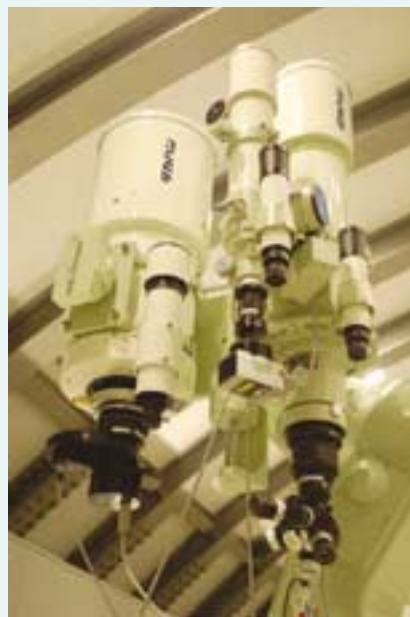
図1: スライディンググループ内の観察用望遠鏡。3本の望遠鏡と3本のファインダーが平行に取り付けられている。反射望遠鏡にはCCDカメラを接続してある。
