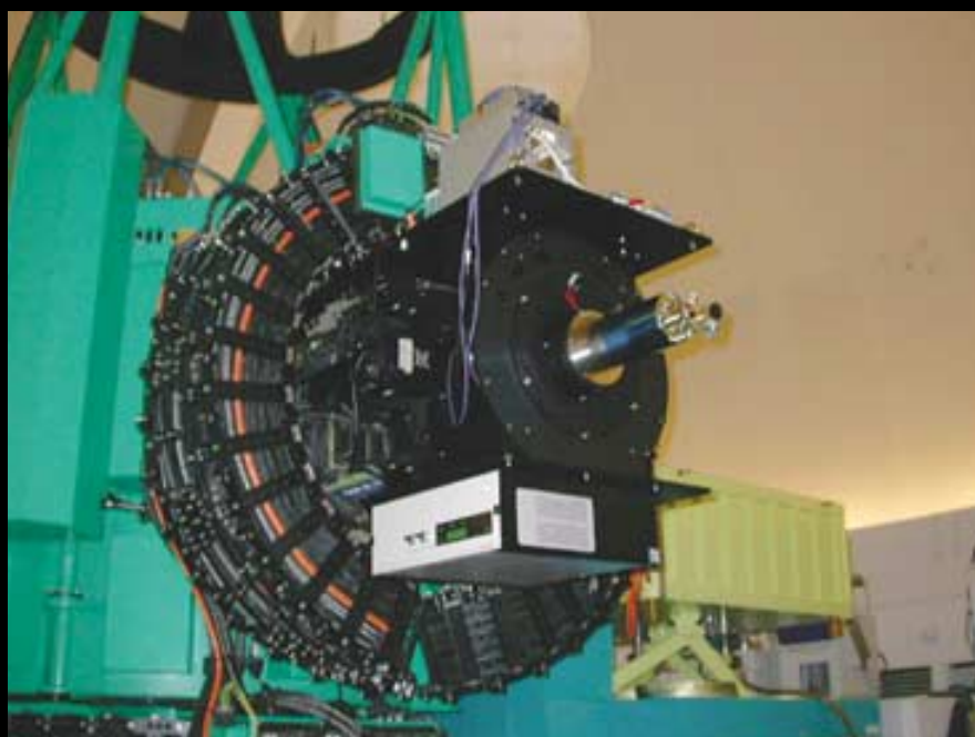
図3：可視低分散分光撮像装置
